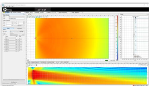
▲ 使用EASE FOCUS 测试新品AC12.3P有源音柱
